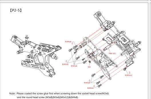
提 示:锁杯头螺丝(M2x6)和圆头螺丝 ( M3x8 ) (M3x6 ) (M3x12)& ( M4x8 ) 时需先涂上螺丝胶。
